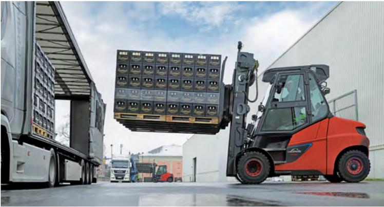
**20 abzufertigende Voll- und Leergut-Lkw in Spitzenzeiten:** Diese hohe Arbeitsintensität, kombiniert mit teils langen Wegstrecken, verlangt den Linde E80 bei der Radeberger Gruppe einiges ab. Daher sorgt eine individuell entwickelte Ladelogik inklusive halbstündiger Ladestopps während der Arbeitspausen (9 und 18 Uhr) für größtmögliche Verfügbarkeit.
