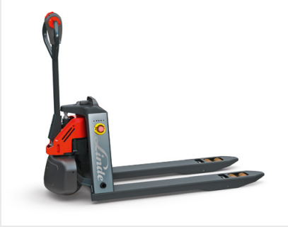
Lange Deichsel an tiefgezogenem Chassis
