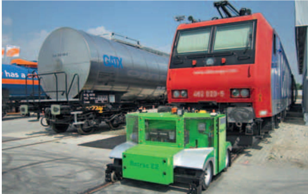
Beeindruckend: Der Rotrac E2 ist extrem kompakt gebaut und kann Anhängelasten von 200 Tonnen sicher ziehen.
